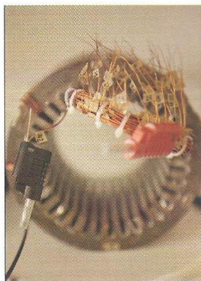
Bobine en phase de test.
